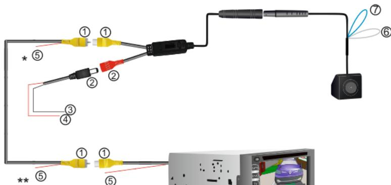
1. Видео провод (передача видео сигнала с камеры на монитор)
